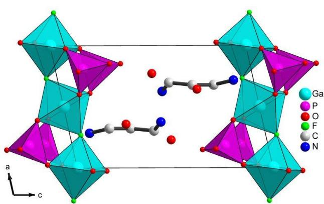
$\text{Ga}(\text{HPO}_4)_2\text{F} \cdot \text{H}_3\text{N}(\text{CH}_2)_3\text{NH}_3 \cdot 2\text{H}_2\text{O}$  [118]
